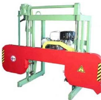
предназначены для продольной распиловки бревен на брус, доску, шпон при рациональном индивидуальном раскрое, малой толщине пропила и минимальных потерях древесины.
