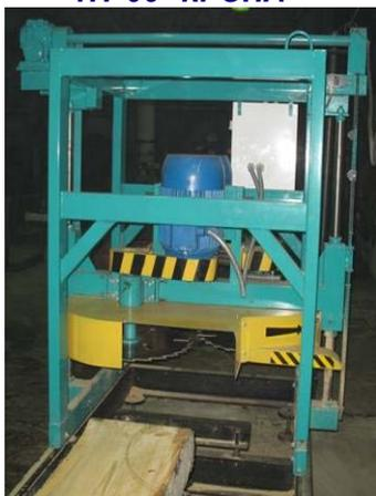
Предназначена для продольной распиловки бревен на брус, доску, шпон при рациональном индивидуальном раскросе, малой толщине пропила и минимальных потерях древесины.
