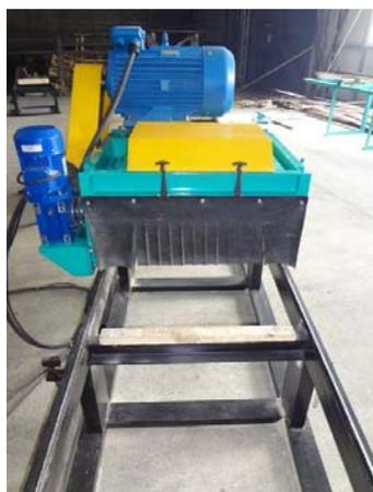
предназначен для операции продольного пиления двухкантного бруса с целью получения обрезного пиломатериала. Станок рекомендуется применять в технологическом цикле с ленточной пилорамой серии ПТ.
