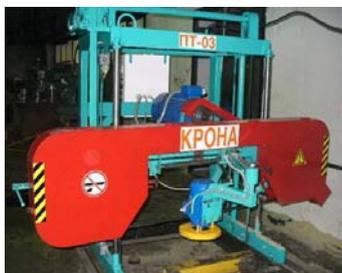
предназначены для продольной распиловки бревен на брус, доску, шпон. Ленточная пилорама комплектуется устройством корорезным (дебаркер), предназначенное для удаления коры и загрязнений с распиливаемой заготовки (бревна) из места пропила.
