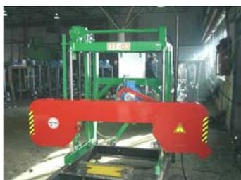
предназначены для продольной распиловки бревен на брус, доску, шпон. Для эффективной работы пилорамы ПТ-03У "КРОНА" и аналогичные рекомендуется комплектовать заточным устройством ЗУ-02 "Термит", разводным устройством УР-05 и комплектом ленточных пил "Uddeholm". Производительность станков, проверенная потребителями, в пределах 6 - 10 м<sup>3</sup> пиломатериала в смену.
