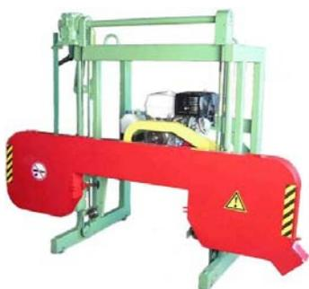
предназначены для продольной распиловки бревен на брус, доску, шпон при рациональном индивидуальном раскрое, малой толщине пропила и минимальных потерях древесины.
