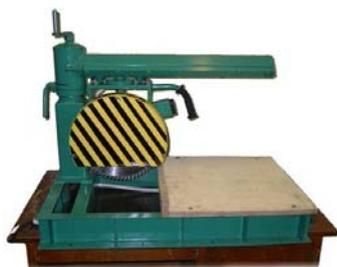
предназначен для выполнения операции торцевания кромки досок, брусьев, древесно-стружечных плит под прямым углом, со скосом по сечению до 10°. Станок торцовочный настольного исполнения крепится к горизонтальной поверхности стола или верстака.
