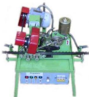
предназначено для заточки, восстановления или изменения профиля зуба ленточных пил. В нашем модельном ряду представлены два вида заточных устройств:
