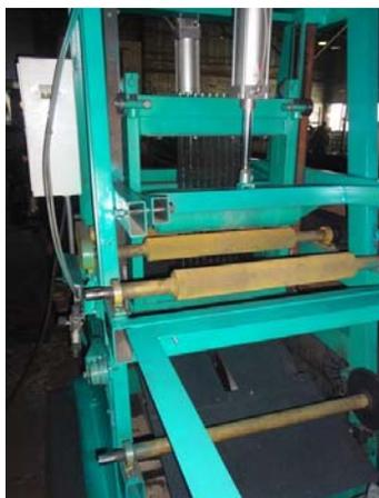
предназначен для высокопроизводительной и экономичной распиловки лафетов (двухкантного и трехкантного бруса) и досок любых пород древесины на рейки, доски и бруски. Принцип действия многопила: конструктивно многопил представляет собой известную многим рамную пилораму.
