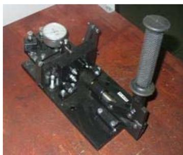
предназначено для разводки зубьев ленточных пил. Надежный и простой станок, в эксплуатации и настройке, позволяющий осуществить разводку зубьев с любым шагом.
