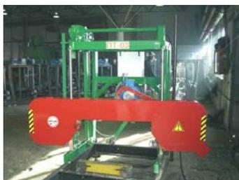
предназначен для продольной распиловки бревен на брус, доску, шпон. Для эффективной работы пилорамы ПТ-04У "КРОНА" и аналогичные рекомендуется комплектовать заточным устройством ЗУ-02 "Термит", разводным устройством УР-05 и комплектом ленточных пил "Uddeholm".
