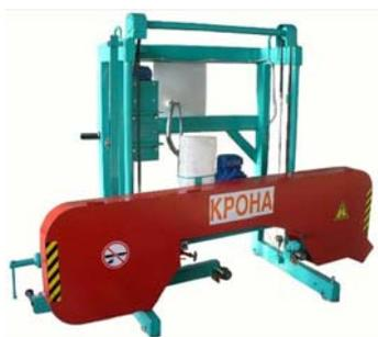
предназначены для продольной распиловки бревен на брус, доску, шпон. Для эффективной работы пилорамы ПТ-05У "КРОНА" и аналогичные рекомендуется комплектовать заточным устройством ЗУ-02 "Термит", разводным устройством УР-05 и комплектом ленточных пил "Uddeholm". Производительность станков, проверенная потребителями, в пределах 6 - 10 м<sup>3</sup> пиломатериала в смену.
