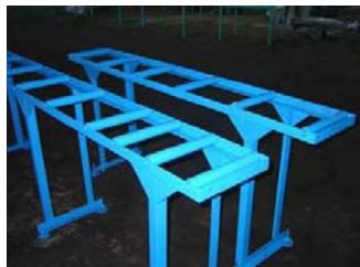
предназначены для транспортировки и выполнения технологических операций с большим спектром заготовок и конечных изделий в деревообрабатывающих и прочих предприятиях.
